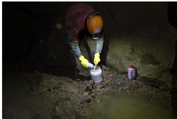
Abb. 4: Einspeisung von Uranin etwa 50 m vor dem derzeitigen Endsiphon in der Bullenhöhle in das aktive Höhlengerinne. Einspeiser A. Glitzner (Foto: R. Seebacher).
