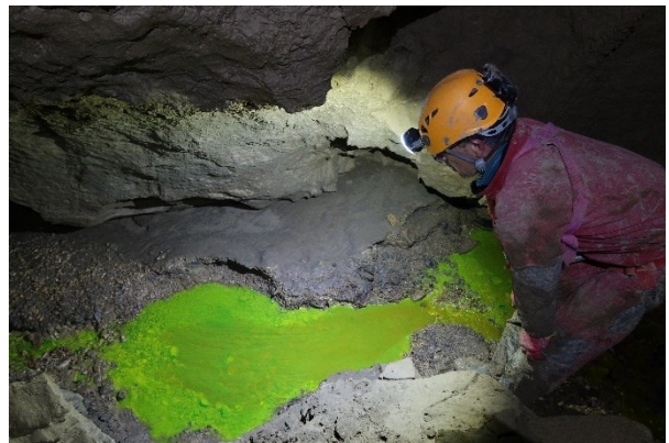
Abb. 4: Einspeisung von Uranin etwa 50 m vor dem derzeitigen Endsiphon in der Bullenhöhle in das aktive Höhlengerinne. Einspeiser A. Glitzner (Foto: R. Seebacher).
