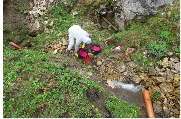
Abb. 3: Einspeisung von Sulforhodamin G in den Schnittlamoos-Ponor. Auflösung des Tracers in 2 x 15 L Schwidenwasser. Einspeiser F. Schmidt in Schutzkleidung (Foto: R. Benischke).
