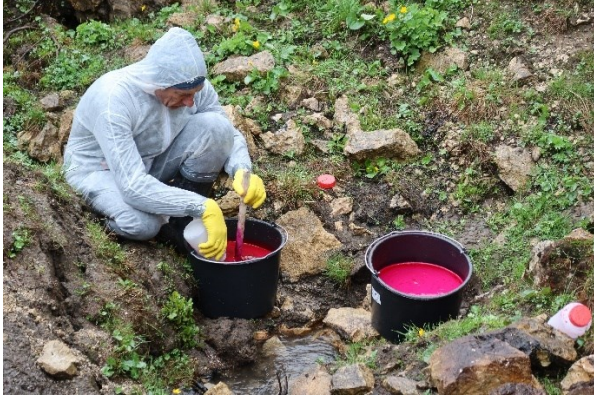
Abb. 3: Einspeisung von Sulforhodamin G in den Schnittlamoos-Ponor. Auflösung des Tracers in 2 x 15 L Schwidenwasser. Einspeiser F. Schmidt in Schutzkleidung (Foto: R. Benischke).
