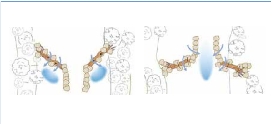
Abb. 17: Modifizierte Trichterbuhne in deklinanter und inklinanter Ausrichtung © Schemaskizze IB Parthl
