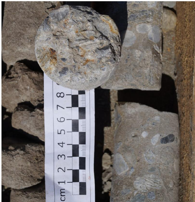
Abbildung 17: Konglomerat aus der Bohrung Söding 1 aus einer Tiefe von ca. 610 m.
