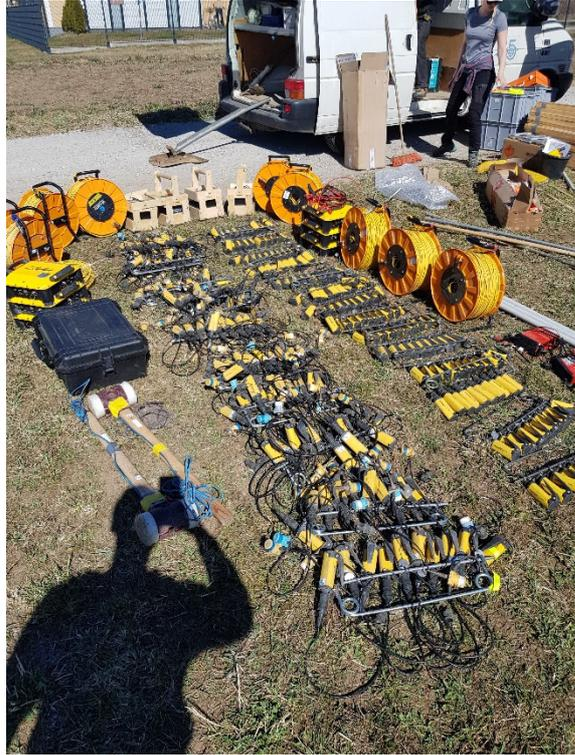
Abbildung 3: Seismische Messkomponenten [Summit XOne (DMT)]
