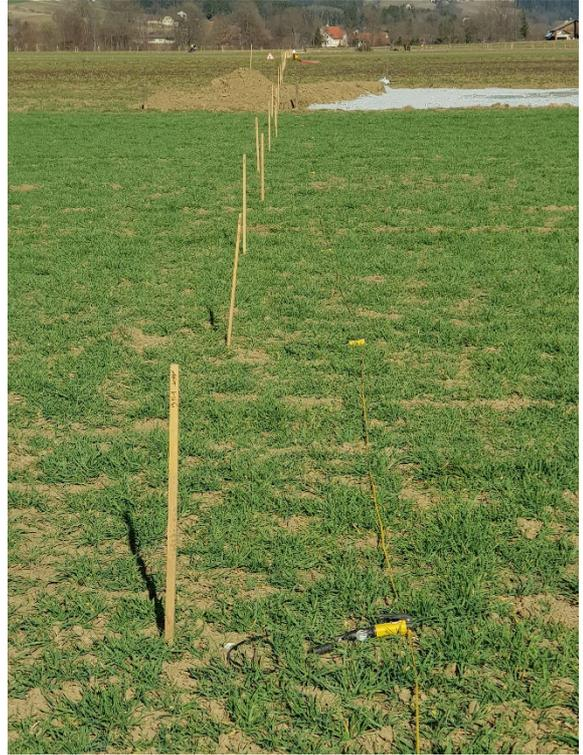
Abbildung 4: Ausschnitt von der Messlinie. Geophonabstand 5 m
