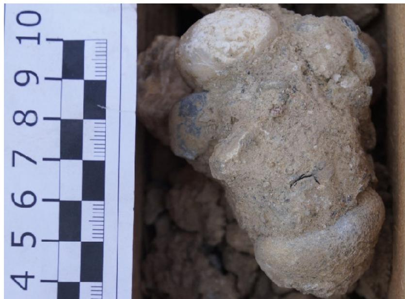
Abbildung 18: Schotter aus der Bohrung Söding 1 aus einer Tiefe von ca. 150 m.
