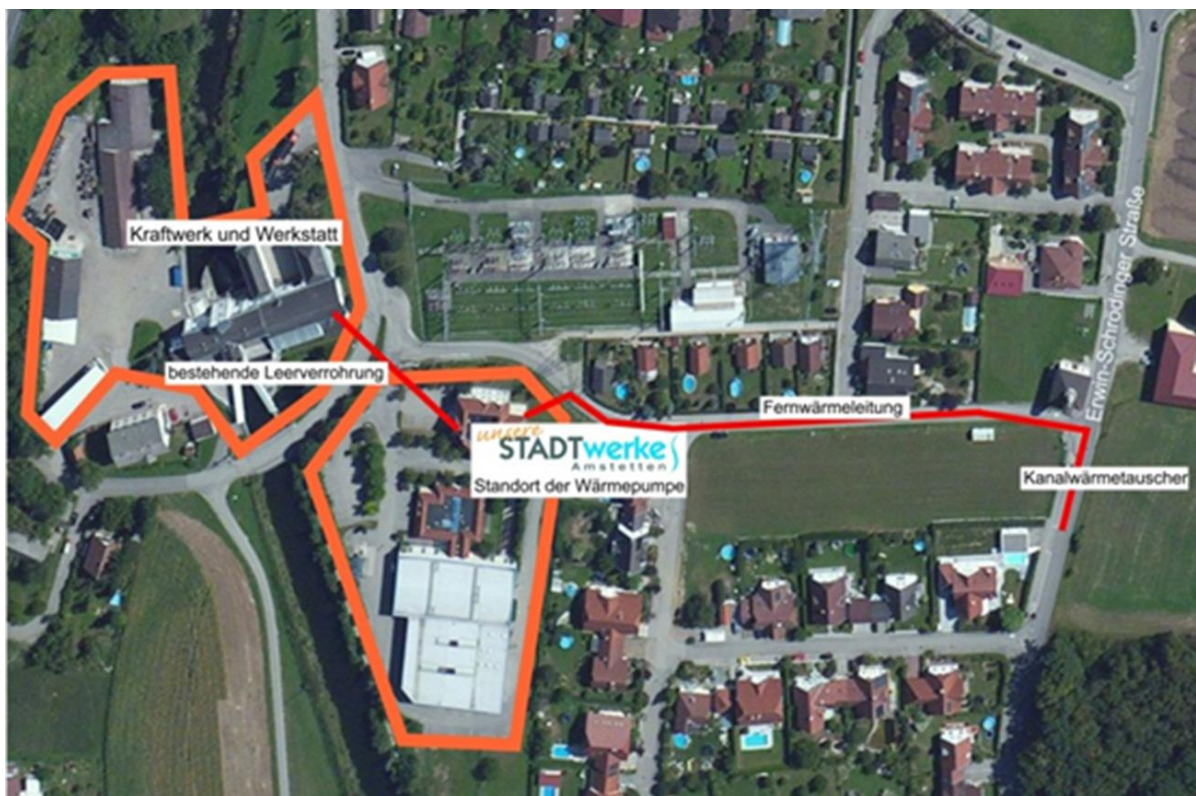
Abb. 11: Thermische Abwassernutzung in Amstetten durch die STADTwerke Amstetten (Quelle: Projektteam Abwasserenergie 2017) 11
