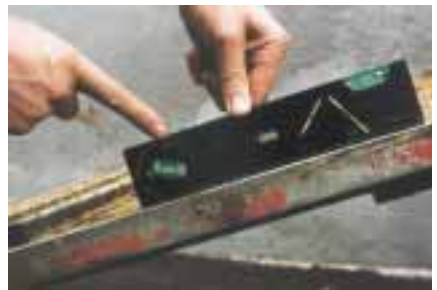
Messung der Laderampenneigung
