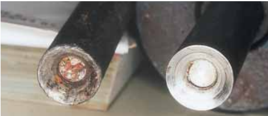
Defekter und intakter Schussbolzen
