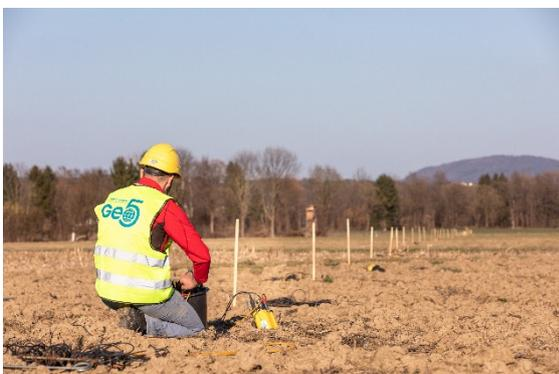
Abbildung 5: Seismikprofil mit Holzpflocken an jeder Geophonposition
