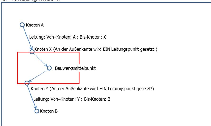
Die Leitungen innerhalb des Sonderbauwerks werden als fiktive Leitungen (=NF-Leitungen) erfasst.
