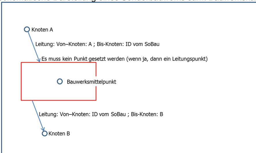
In zufließenden Leitungen sind die Attribute des *Von-Knotens* mit der ID des Knotens A und der *Bis-Knoten* mit der ID des Sonderbauwerkes zu befüllen.
