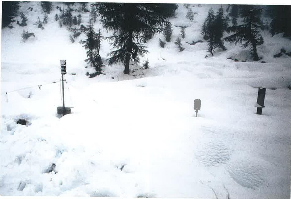
Bild 2: Klimadatenerfassung am Albert-Appel-Haus (1636 m NN) mit transportabler Klimameßstation: Temperaturmesser und Hygrometer mit Datenlogger, Hellmann'scher Regenschneemessgerät, Ombrometer (von links nach rechts).
