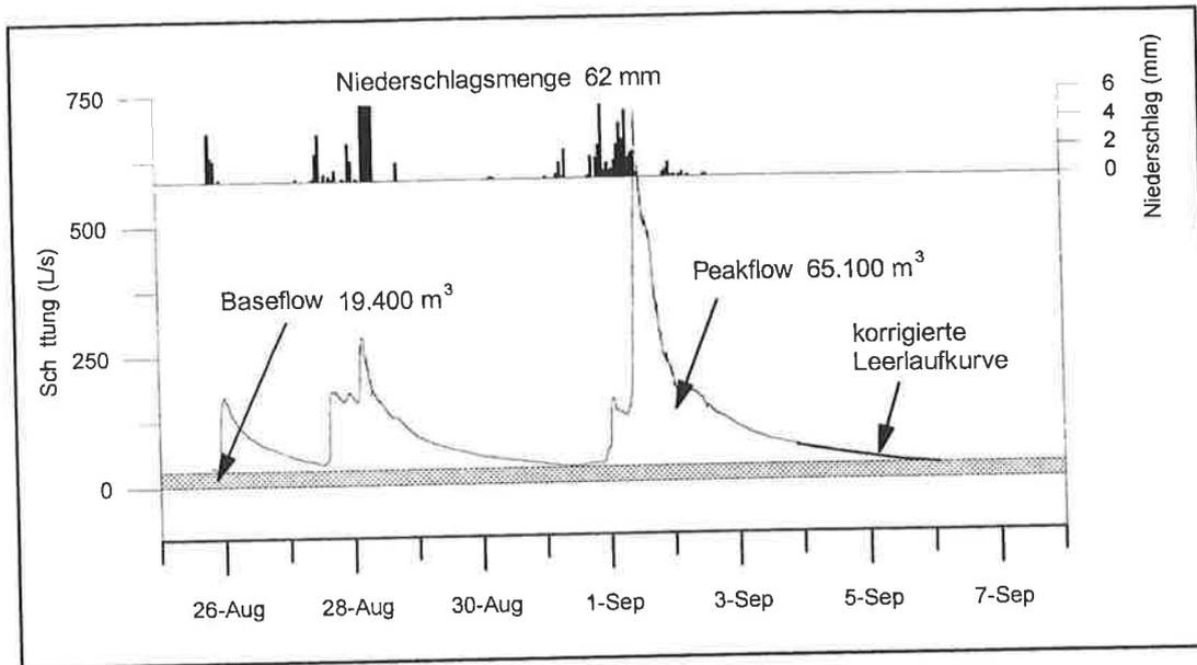
Abb. 5.25: Niederschlag und Peak- / Baseflowtrennung an der Zimitzquelle für 30 l/s Baseflow. Die angegebenen Wassermengen geben Base- und Peakflow-Volumen im Zeitraum vom 26.8. bis 6.9.1996 an.
