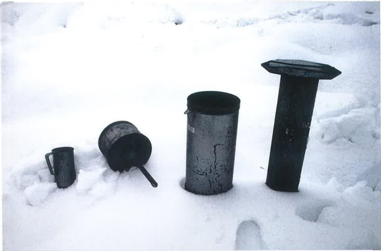
Bild 3: Das Ombrometer: Auffanggefäß, Auffangtrichter mit Ablaufrohr, Basisrohr, Standfuß.
