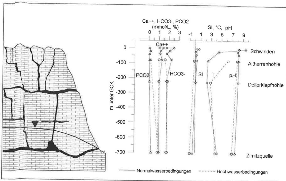
Abb. 5.20: Überblick über die Verteilung der  $Ca^{++}$ ,  $HCO_3^-$ -Konzentration, des  $P_{CO_2}$ , des  $SI_{Kalzit}$ , des  $pH$ -Werts und der Wassertemperatur bei Hochwasser- und Normalwasserbedingungen in Abhängigkeit von der Tiefe unter der Geländeoberkante (GOK).
