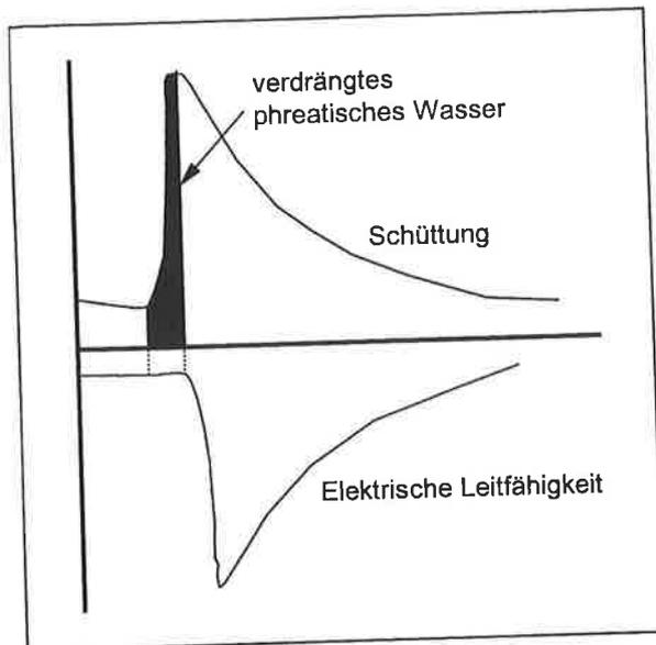
Abb. 5.19: Das Prinzip des Piston-Flow-Effekts, dargestellt anhand der Verzögerung der elektrischen Leitfähigkeit im Vergleich zur Schüttung.
