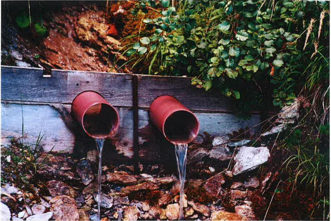
**Abb. 1:** Meßwehr mit zwei parallel geführten Abflußrohren
