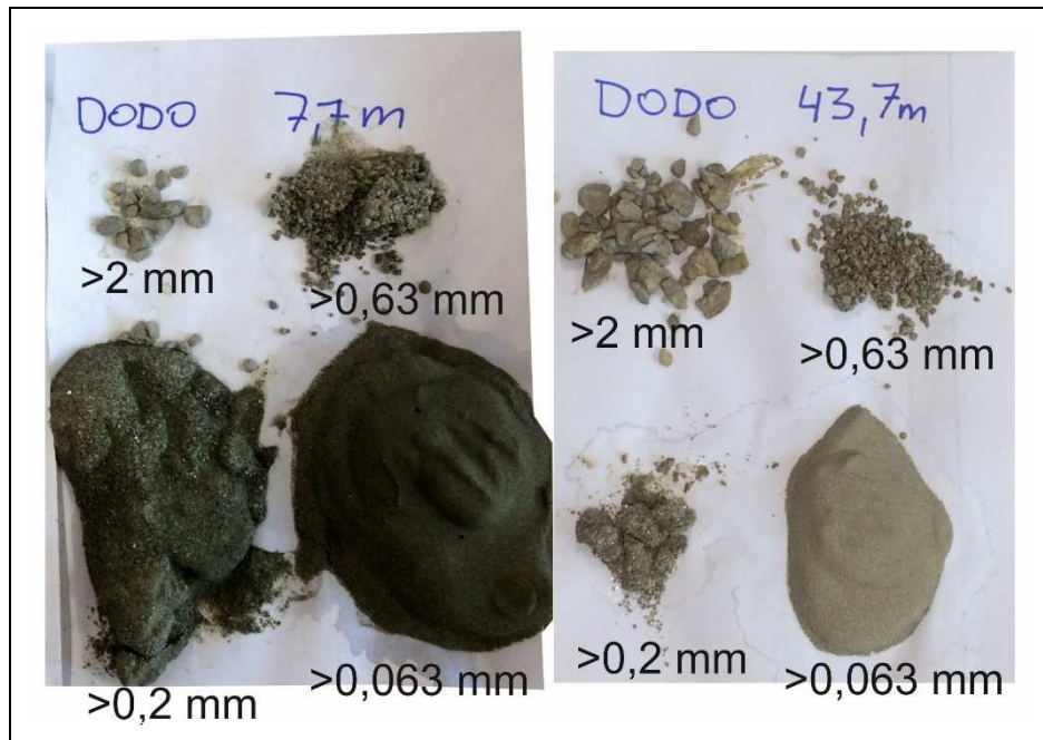
Abbildung 5.14: TGWM Dobersdorf – gesiebte Bohrkleinproben. links: 7,7 m – Neogen (stark schluffiger Mittel- bis Feinsand). rechts: 43,7 m – Neogen (Tonmergel bis Mergelstein, tonig).
