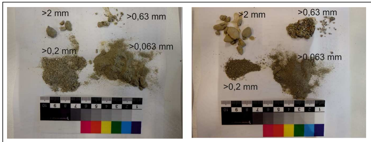
Abbildungung 4.5: TGWM Zöbing – gesiebte Bohrkleinproben. links: 35,8 m – mittel-feinsandiger Schluff. rechts: 69,8 m – (Fein) Sand, kiesig, schluffig.
