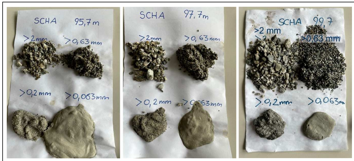
Abbildung 5.30: TGWM Schachendorf – gesiebte Bohrkleinproben 95,7, 97,7 m, 99,7 m. Basale Entwicklung: graugrüne Sande bis Kiese (fining upward) gering schluffig, Kohle- schmitzen (liegender Abschnitt des Ausbauhorizontes).
