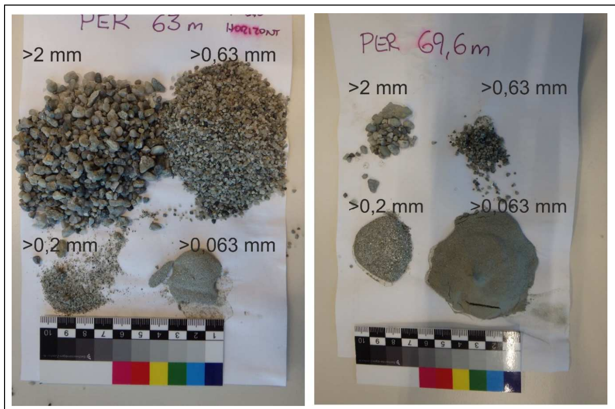
Abbildung 4.25: TGWM Pertlstein – gesiebte Bohrkleinproben. links: 63,6 m – Ausbauhorizont (grobsandige Feinkiese). rechts: 69,6 m – neogene feinsandige Schluffe mit Tonmergelsteinlagen.
