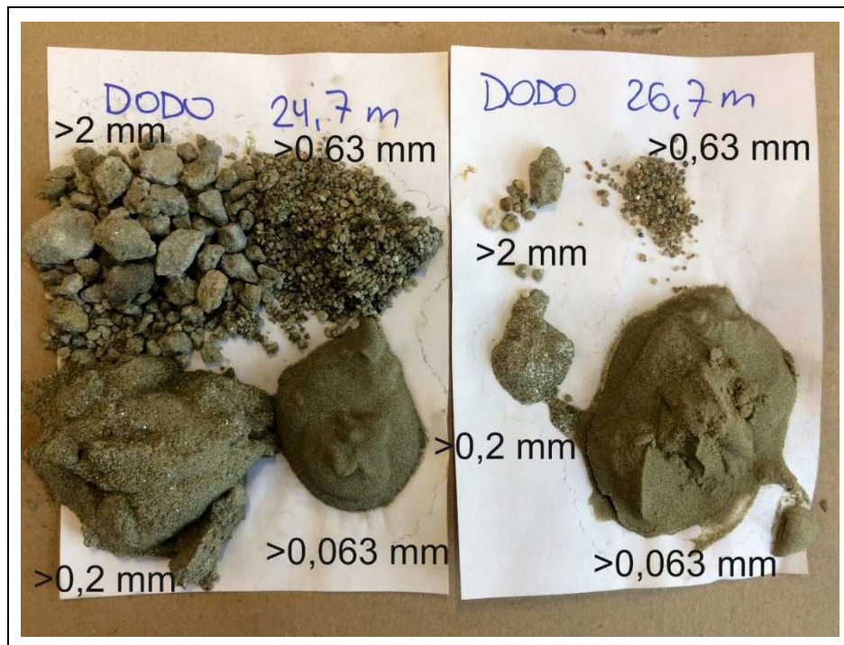
Abbildung 5.13: TGWM Dobersdorf – gesiebte Bohrkleinproben. links: 24,7 m – Vulkanit (basaltische Tuffe; Pliozän?). rechts: 26,7 m – Neogen (mittel- bis grobsandiger, schluffiger Feinsand, gering feinkiesig, Mergelsandstein-Bruchstück).
