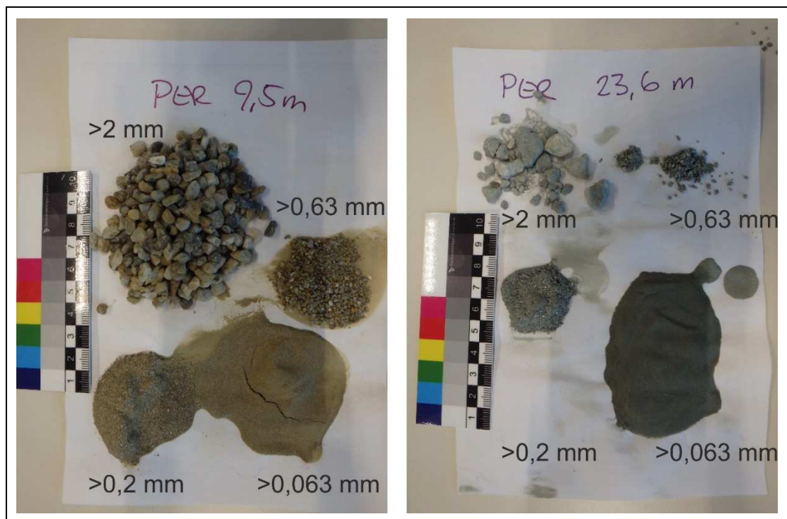
Abbildung 4.23: TGWM Pertlstein – gesiebte Bohrkleinproben. links: 9,5 m - quartärer Grundwasserleiter (Feinkiese-Sande). rechts: 23,6 m - neogene sandige Tonmergel mit Tonmergelsteinlagen.
