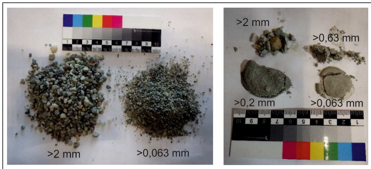
Abbildungung 4.6: TGWM Zöbing – gesiebte Bohrkleinproben. links: 77,8 m – Ausbauhorizont, wenig fein- bis mittelsandiger, wenig schluffiger Grob- sand bis Feinkies. rechts: 85,8 m – Endteufe Schluff bis Ton, sandig (?Nachfall Feinkies).
