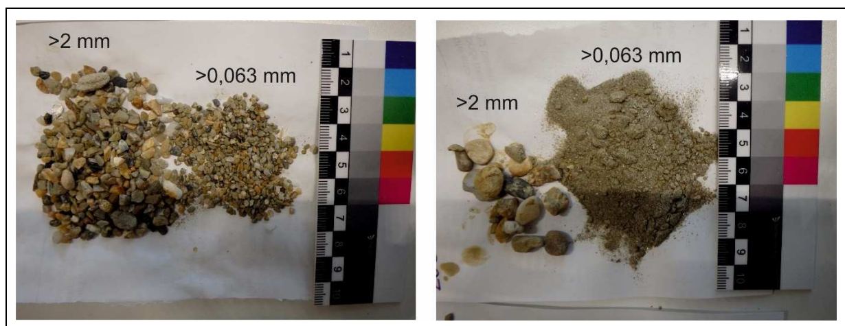
Abbildung 4.4: TGWM Zöbing – gesiebte Bohrkleinproben. links: 6,0 m - quartärer Grundwasserleiter. rechts: ca. 15 m - Grenze Quartär/Neogen.
