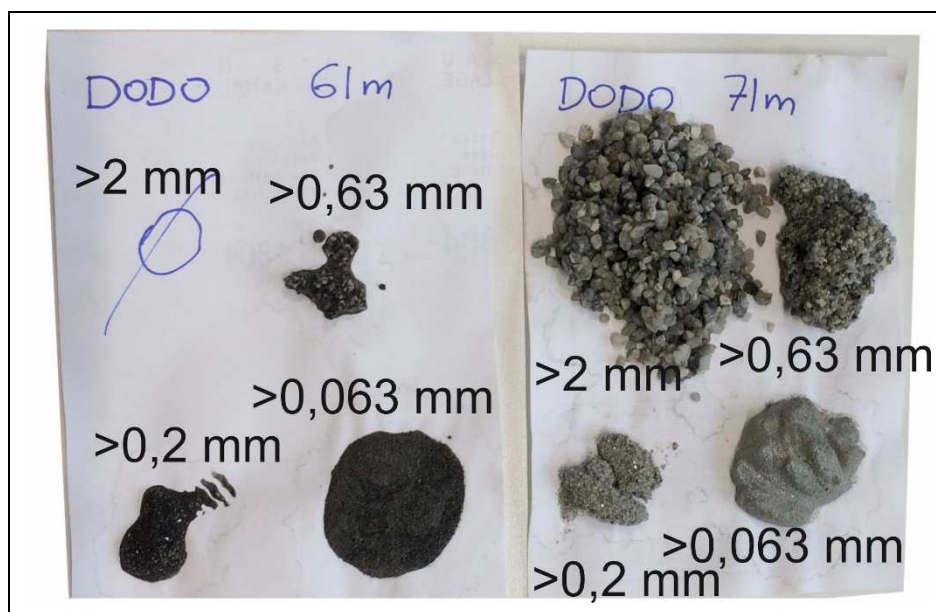
Abbildung 5.15: TGWM Dobersdorf – gesiebte Bohrkleinproben. links: 61,7 m – bituminöse Tone. rechts: 71,7 m – Ausbauhorizont (sandiger Feinkies).
