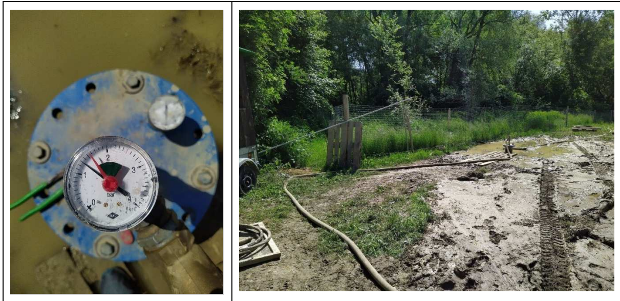
Abbildung 4.7: TGWM Zöbing – Probenahme. links: Sondenkopf mit Manometer und Druckschlauch-Abgang, rechts: Pegel mit Ausleitungsschlauch.
