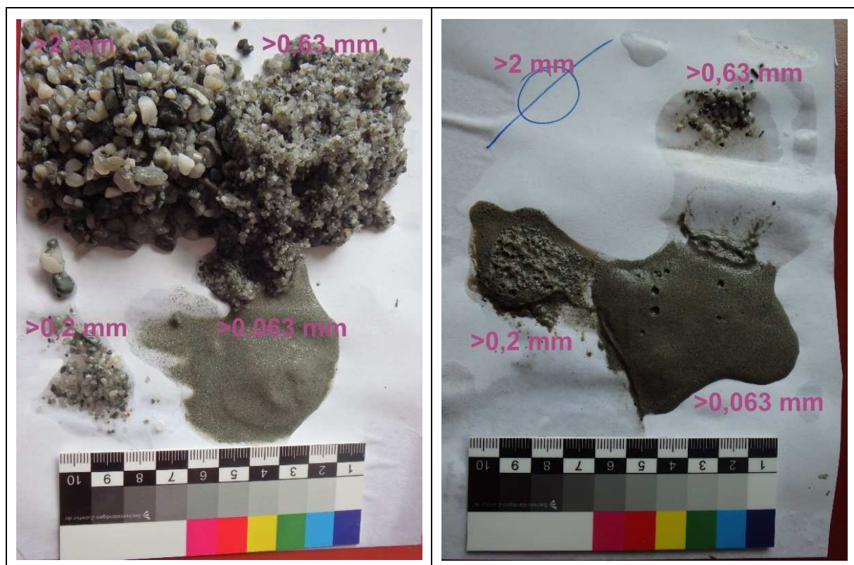
Abbildung 4.11: TGWM Untergroßau – gesiebte Bohrkleinproben. links: ca. 55,7,0 m – Ausbauhorizont (gS-fG, m-fs, u') rechts: ca. 67,7 m – (TM-U, fs, Braunkohleschmitzen).
