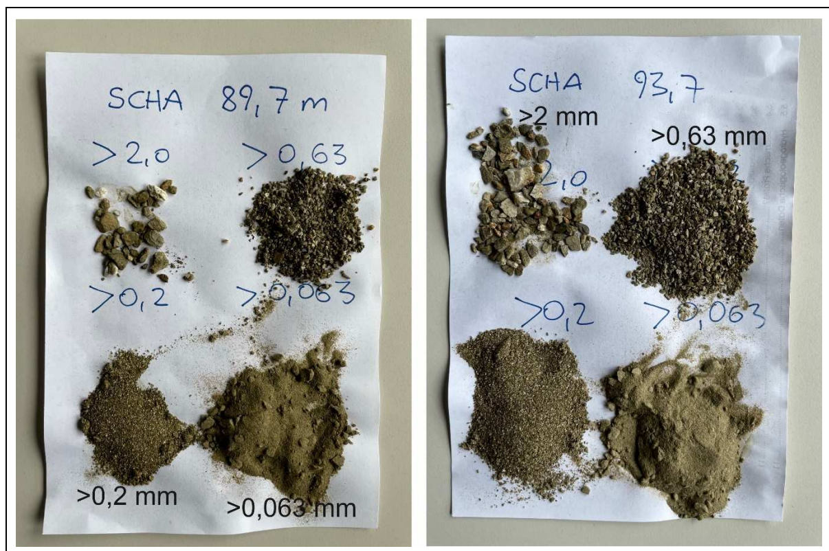
Abbildung 5.29: TGWM Schachendorf – gesiebte Bohrkleinproben 89,7 m, 93,7 m. ockerbraune +/- kiesige Sande, gering schluffig, wenig tonig (hangender Abschnitt des Ausbauhorizontes).
