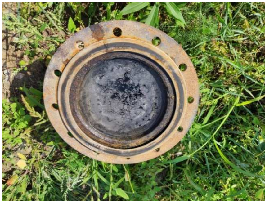
Abbildung 5.23: TGWM Auboden – Probenahme. links: Wasserspiegel im Pegelrohr (mit Sediment-Film). rechts: Probenahme.
