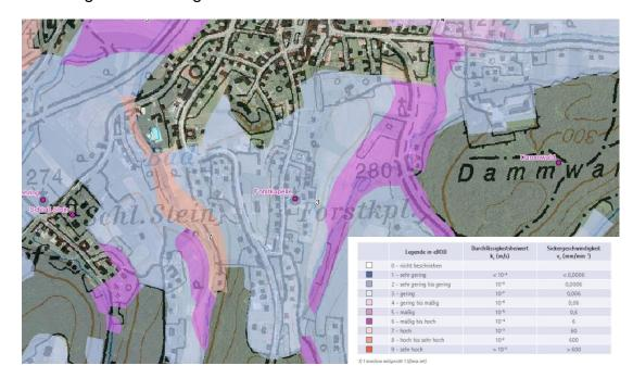
Wie aus der Karte ersichtlich ist, ist im Projektgebiet mit einer Durchlässigkeit von 10<sup>-7</sup> m/s zu rechnen.
