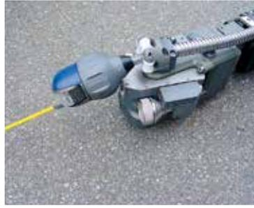
**Abb. 5: Ferngesteuerte Kameras ermöglichen Einblicke in die Kanalrohre und liefern Bilder an die Oberfläche.**
