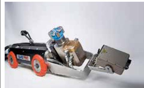
**Abb. 6: Kanalroboter mit Kamera und Fräse. Der Kanalroboter ist für Fahrten im Untergrund optimiert und ermöglicht eine lückenlose digitale Dokumentation der Leitungen. Kleine Reparaturarbeiten können mit dem fahrbaren Werkzeug direkt im Rohr erledigt werden.**
