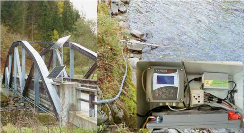
Abb. 2: Dr.-Lange-Trübesonde im Bereich der Stauwurzel Bodendorf
