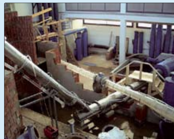
Abb. 5. Modellversuch für ein Wasserschloss bei einem Speicherkraftwerk
