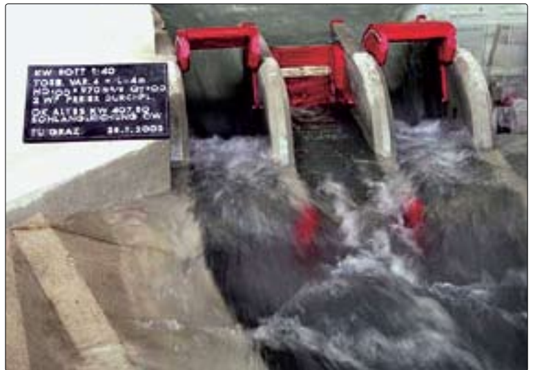
Abb. 1: Modellversuch bei einem Wehr eines Flusskraftwerkes
