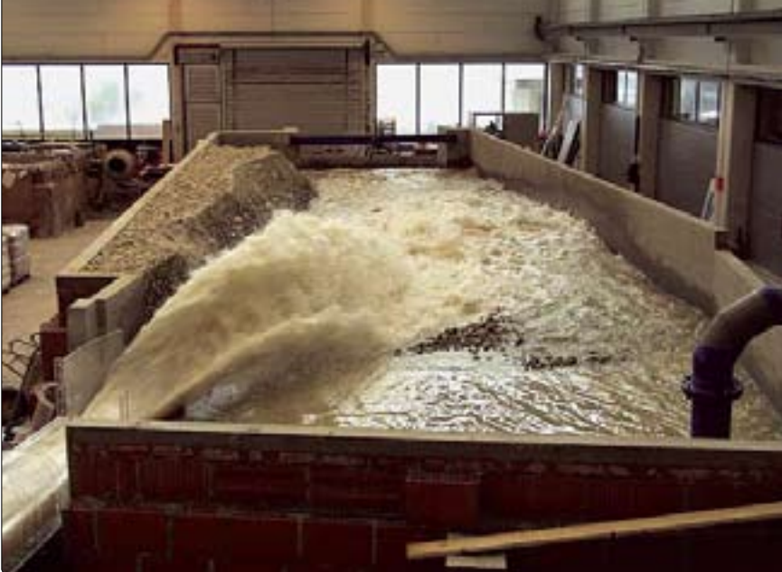
Abb. 2. Modellversuch Grundablass eines Speichers
