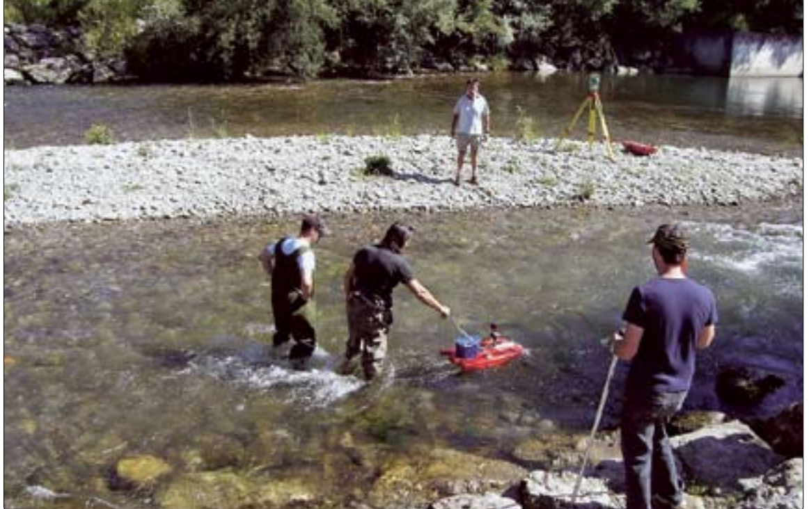
Abb. 6: Bestimmung der Fließgeschwindigkeitsverteilung mit einem „Ultraschallboot“
