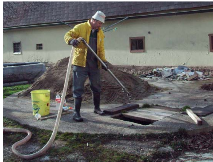
Neuentwickelte Probenentnahme aus Güllegrube mittels Stechlanze
