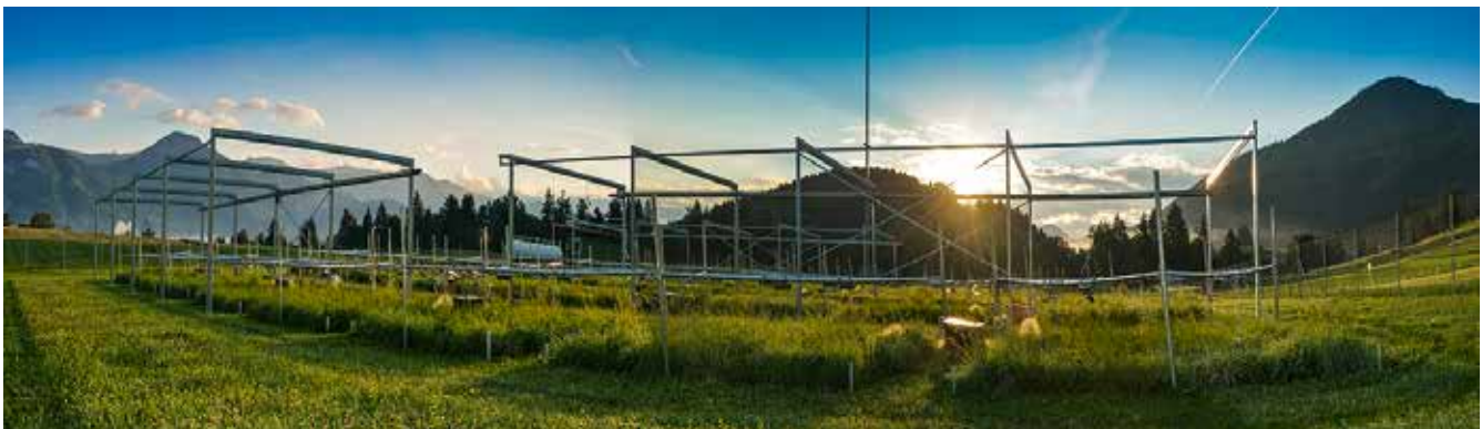
Abb. 1: Freilandexperiment mit Infrarotstrahlern zur Beheizung, Begasungsringen zur CO 2 -Anreicherung, optionalem Regendach sowie Lysimetern zur Erfassung der Wasserhaushaltskomponenten © S. Keiblinger, HBLFA Raumberg-Gumpenstein
