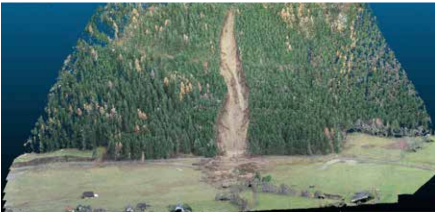
Abb. 12: Urlbach, digitales Geländemodell, erstellt aus den Laserscandaten der Drohnenbefliegung © WLV
