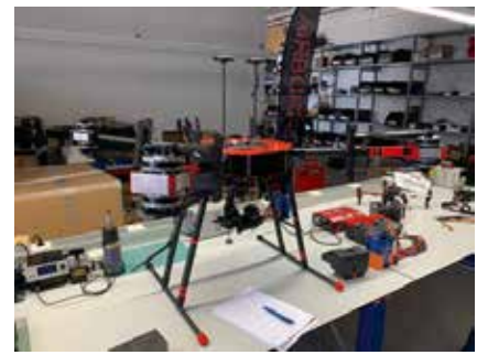
Abb. 3: „Flowcast“: Experimentaldrohne, Tragkraft bis 10 kg © A. Schiller
