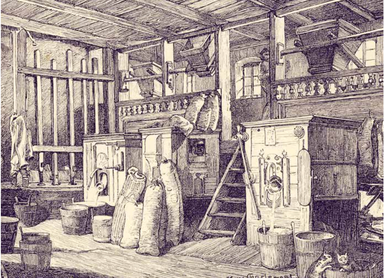
Abb. 1: Inneres einer wasserbetriebenen Mühle in der Steiermark um 1880, links gut zu erkennen sind die fünf „Schießer“ der damit verbundenen Ölstampfe, Grafik von Hugo Charlemont (aus: Kronprinzenwerk)
