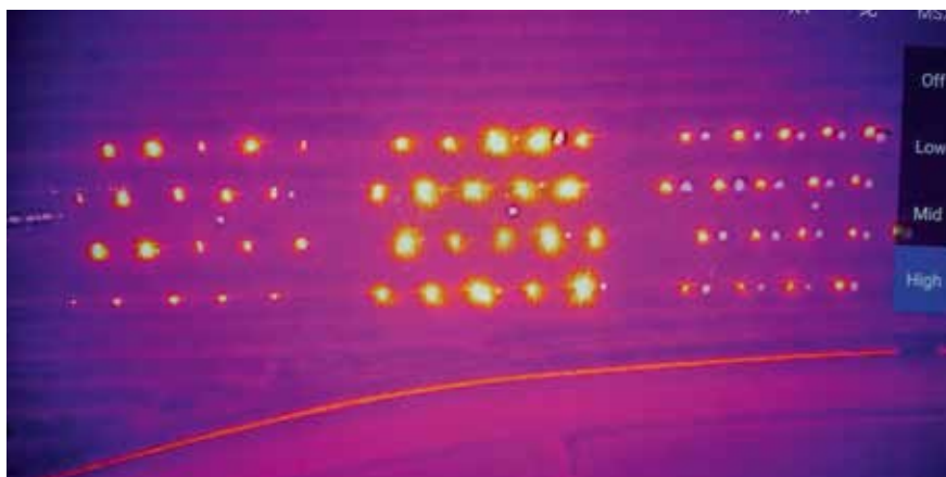
Abb. 3: Aufnahme des Heizversuches der Fa. OPST mit der Wärmebildkamera aus einer Höhe von 150 m über den Versuchsfeldern während der Anheizphase in einem Vorversuch, links: Frostofen Torf, mittig: Frostofen Holzbriketts, rechts: Frostkerze Stoppel © Freiwillige Feuerwehr Pöllau, 28.11.2018
