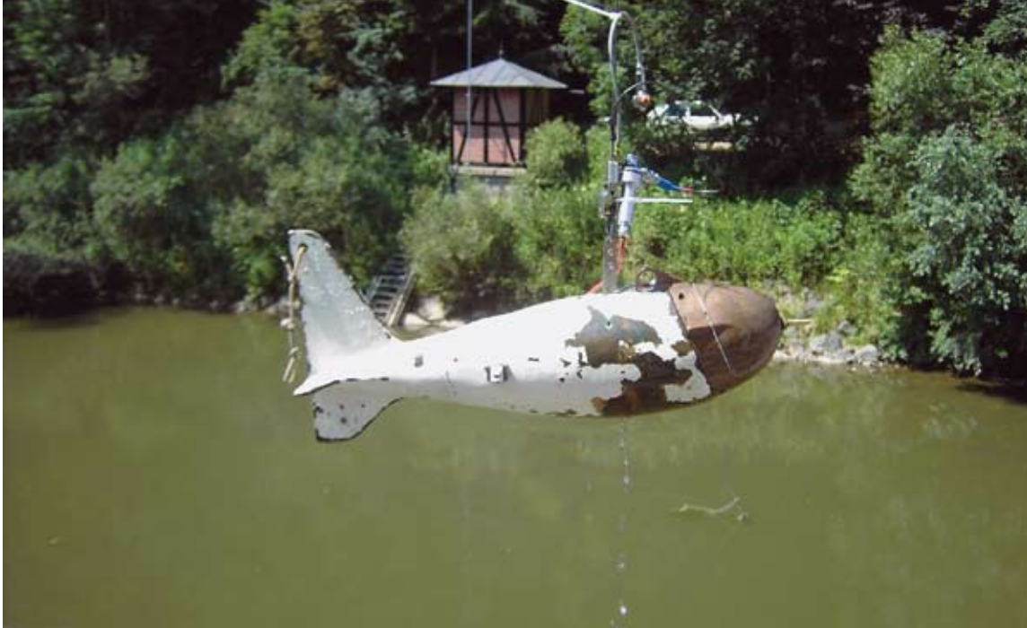
Abb. 2: Schwebstoff-sammler der Type US-P61 Foto Kerschbaumsteiner
