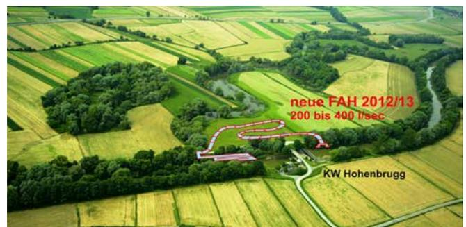
Der Biotopverbund Raab in Hohenbrugg mit Darstellung der neuen als Schlitzpass ausgeführten Fischaufstiegshilfe
