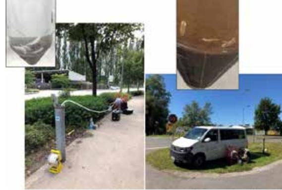
Abb. 2: Grundwasserentnahme für ökologische Untersuchungen im Murtal © C. Griebler
