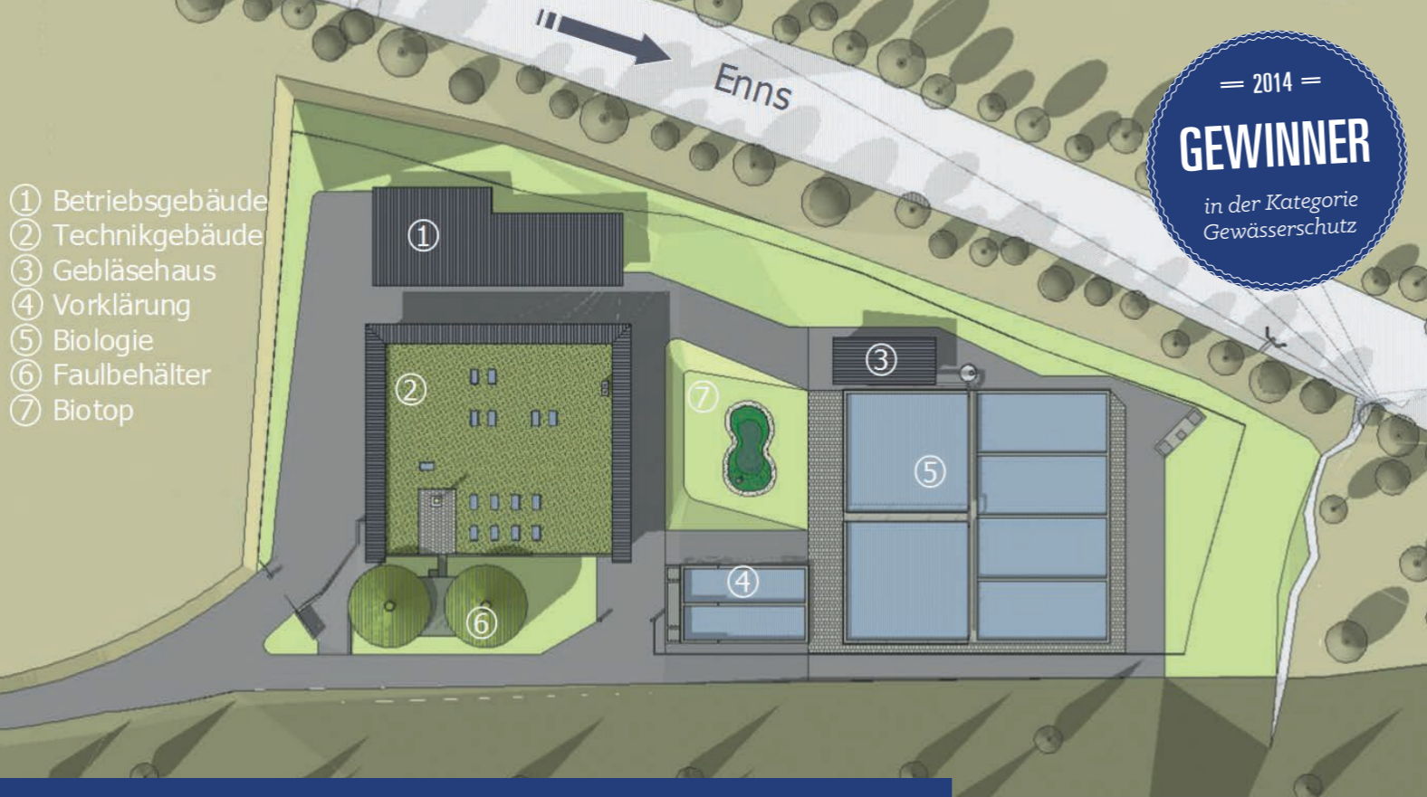
WM-Kläranlage Schlading (Lageplan).
