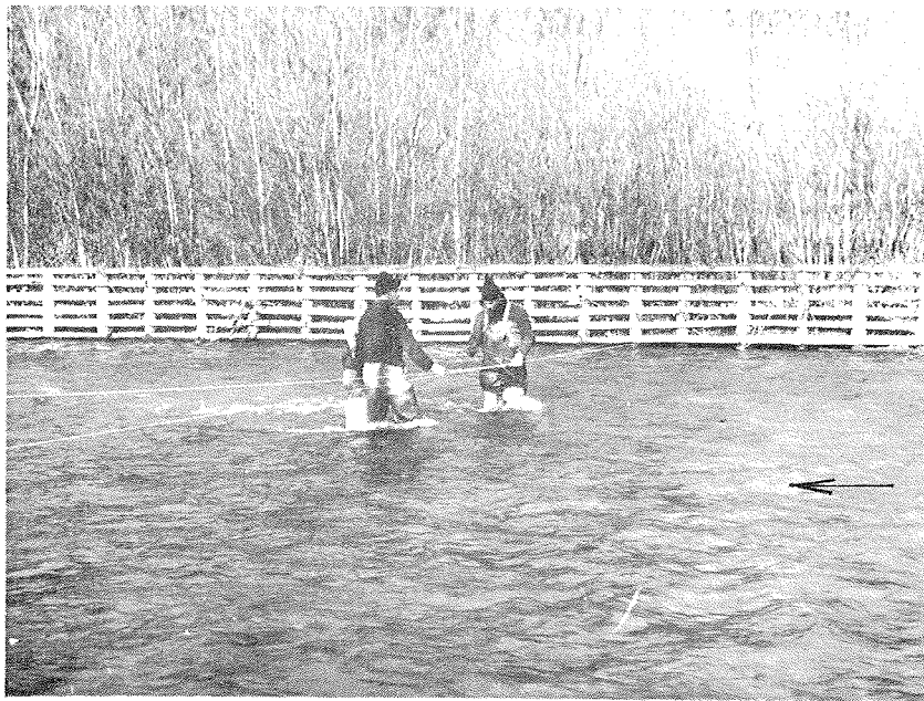
Abb. 22 Einsetzen des Entnahmegerätes im Meßquerschnitt
