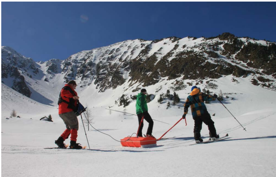
Abbildung 9: Bodenradarmessungen auf der Schneedecke mit einer 100 MHz Antenne.
