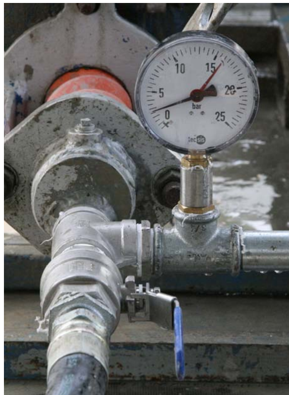
Abb. 38: Ermitteln des optimalen Injektionsdrucks
