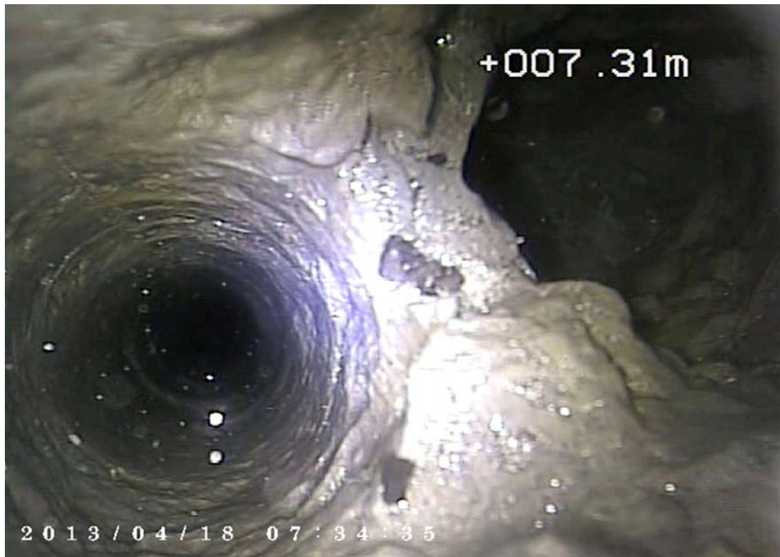
Abb. 33: Unverrohrtes Bohrloch (Abweichung beim nachträglichen Überschlagen)
