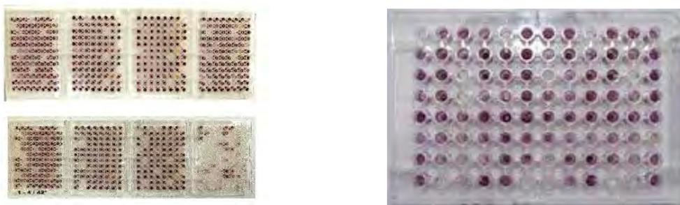
**Abb. 32:** Darstellung der BIOLOG EcoPlates (physiologisches Profil). Die Oxidation der Kohlenstoffverbindungen färbt die dotierten „wells“ je nach Stoffwechselleistung der Bakterien unterschiedlich stark.
