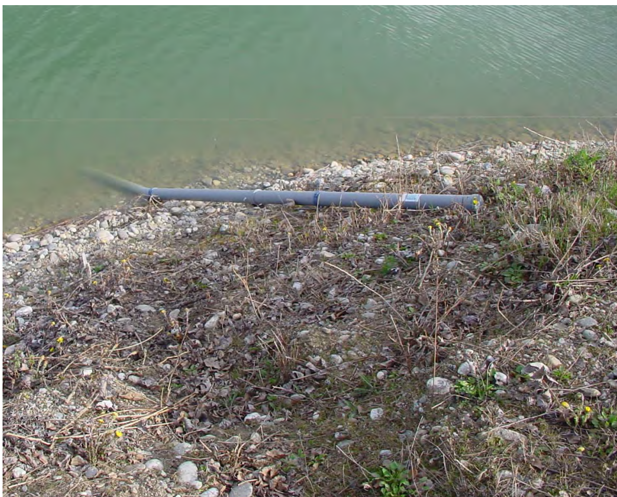
Fig. 107: Datensammler – Messstelle zur Erfassung des See-Wasserspiegels und der See-Temperatur in einem der Teiche
